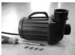
odmontujte šroub z krytu rotoru
